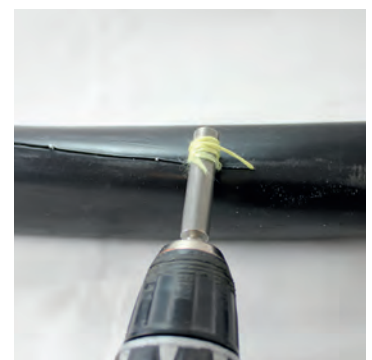
Linki z włókna kevlarowego umieszczone wewnątrz kabla ułatwiają przecinanie i usunięcie powłoki zewnętrznej
